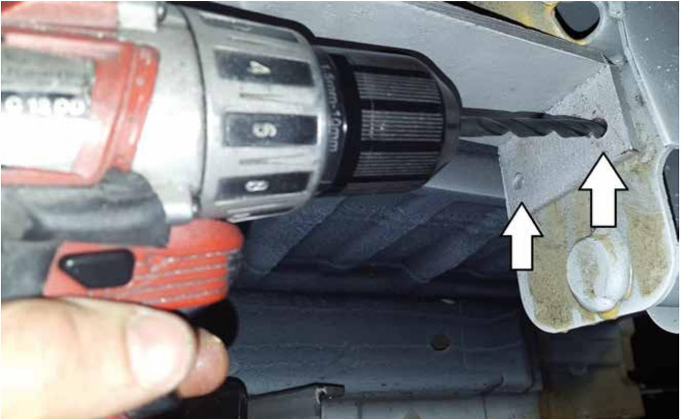
Schuif de adapter op het frame, boor vervolgens twee gaten van 10 mm en bevestig met de bouten.
