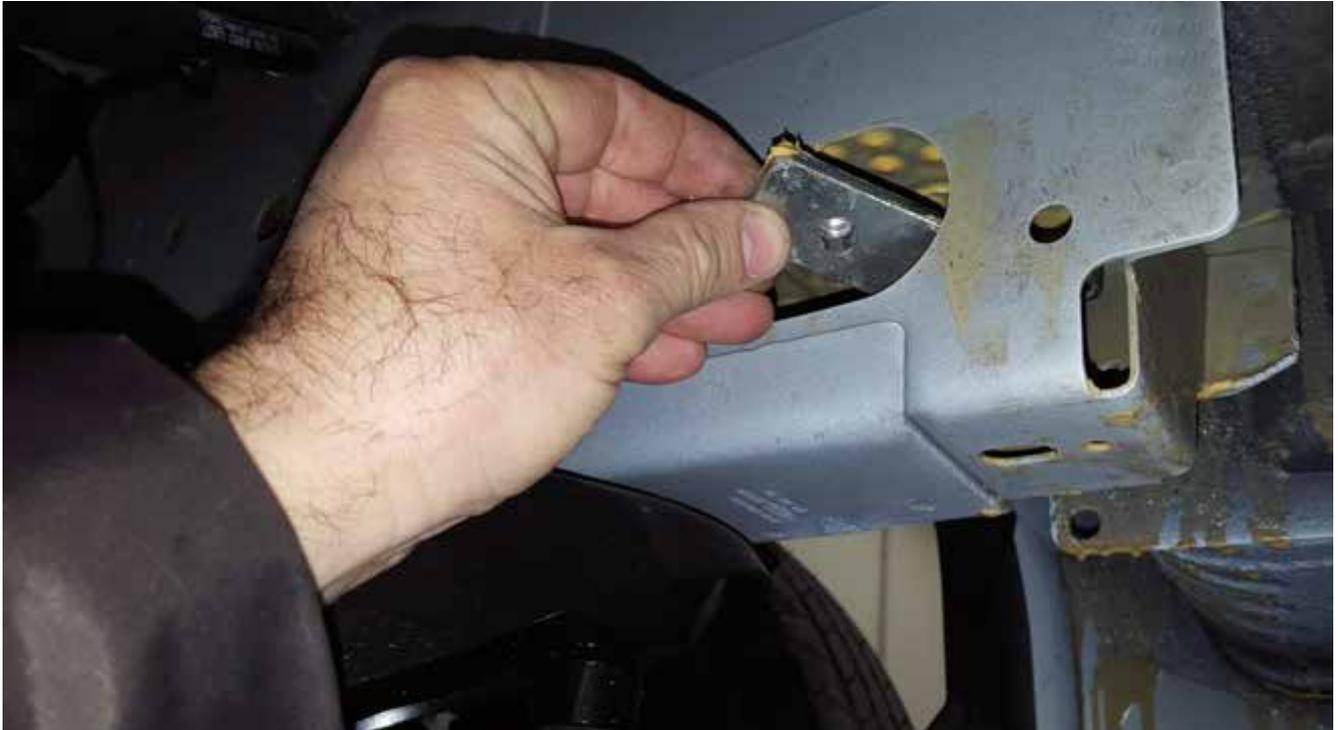
Insérez la plaque d'étanchéité dans le trou du cadre.
