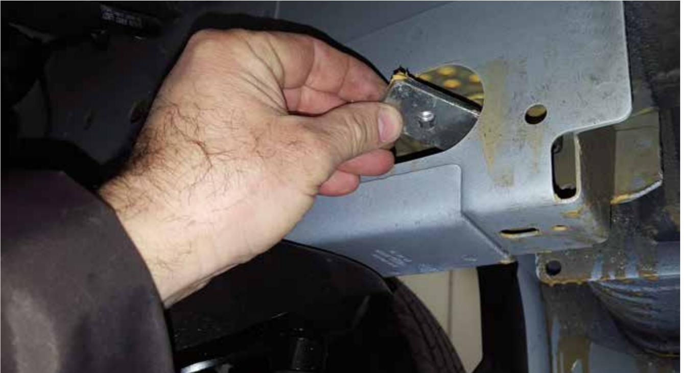
Führen Sie die Dichtungsplatte durch das Loch am Rahmen.
