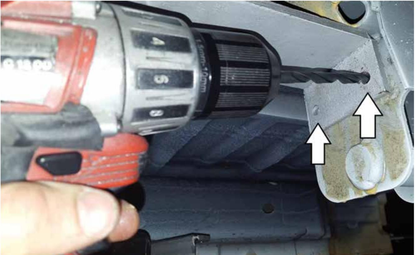
Pousser l'adaptateur sur le cadre, puis percer deux trous de 10 mm et fixer avec les boulons.
