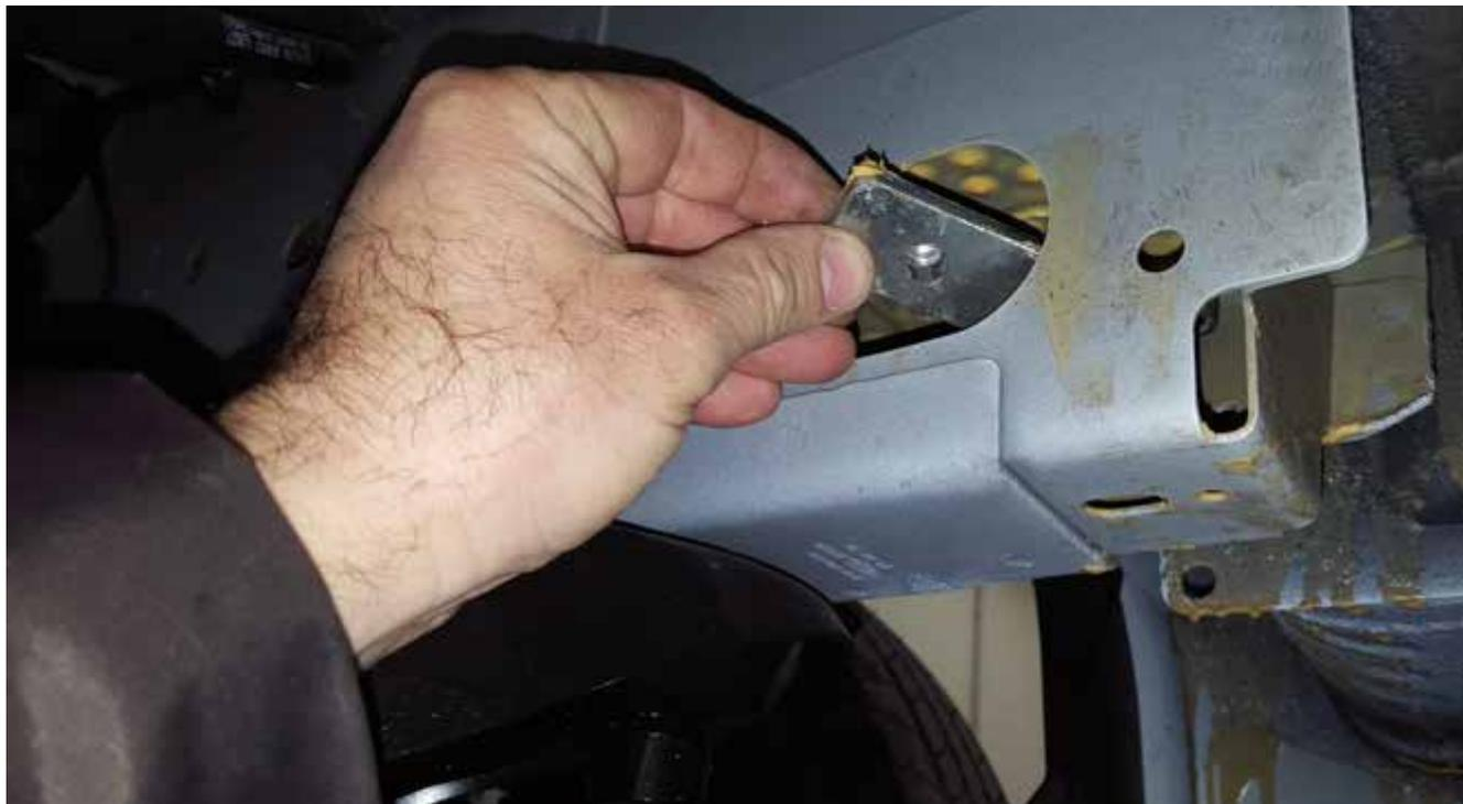
Inserire la piastra di tenuta attraverso il foro sul telaio.
