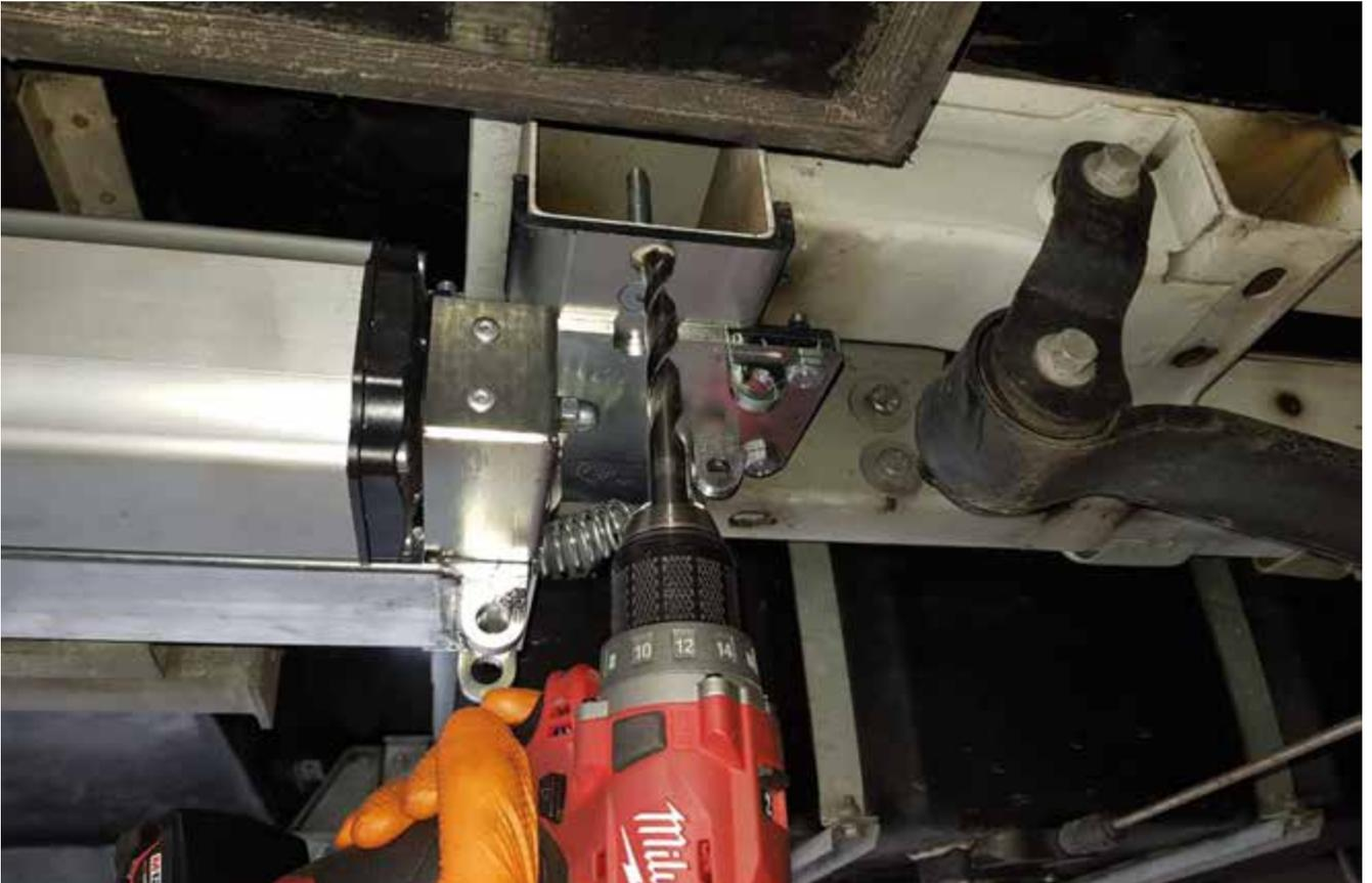
Percez un trou de 13 mm dans le trou de l'adaptateur
