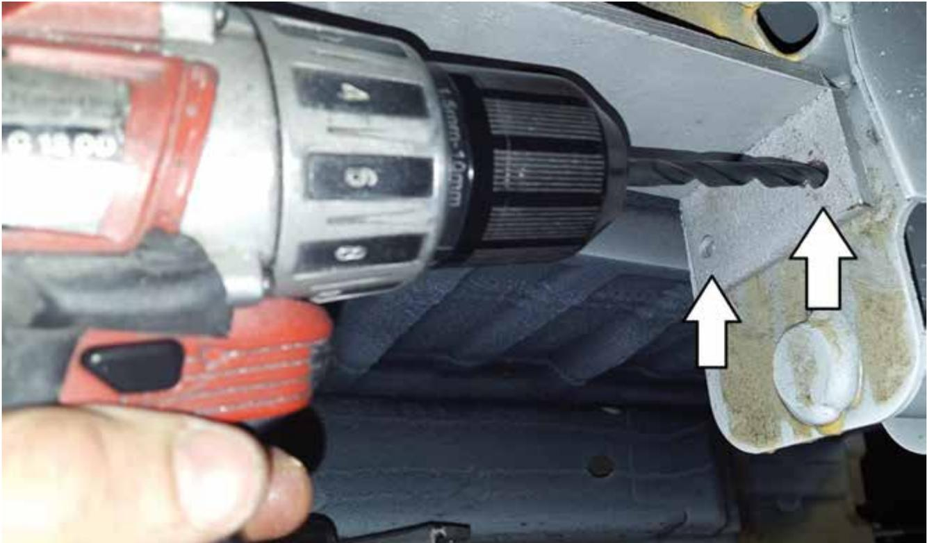
Schieben Sie den Adapter auf den Rahmen, bohren Sie dann zwei 10 mm Löcher und befestigen Sie ihn mit den Schrauben.
