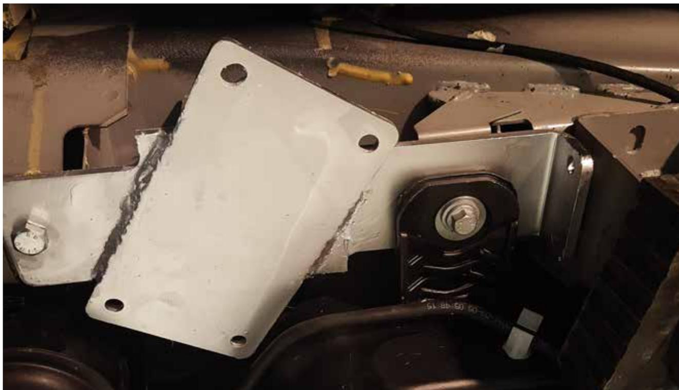
Kiinnitä sovitin M10-pultilla ja kiinnitä AdBlue-säiliön tuki sovittimen yläpuolelle
