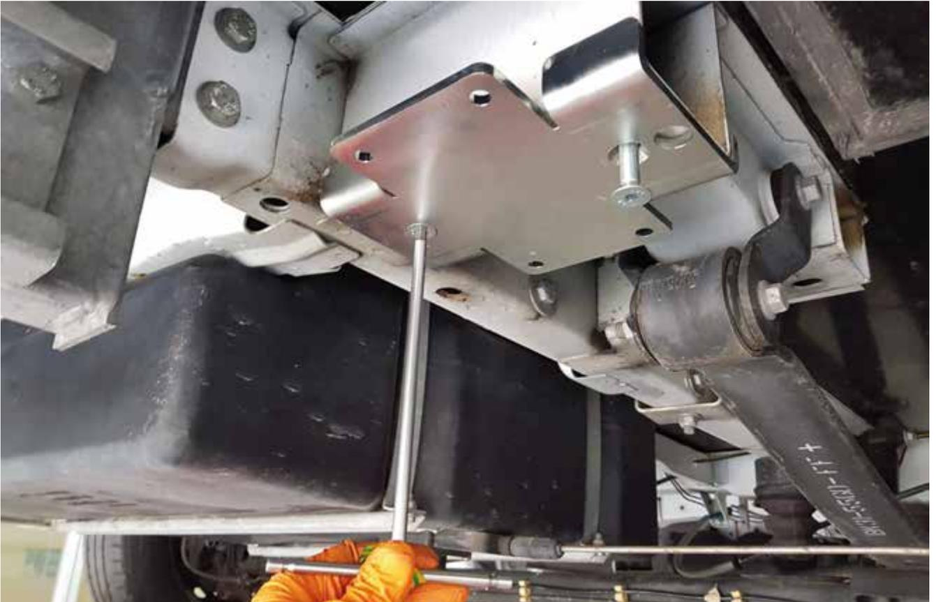
Setzen Sie den Adapter an der abgebildeten Stelle (hinter der Hinterachse) ein, setzen Sie die Dichtungsplatten ein und befestigen Sie den Adapter mit den M10-Schrauben.
