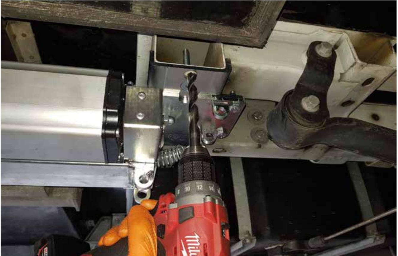
Bohren Sie ein 13 mm Loch durch das Loch im Adapter
