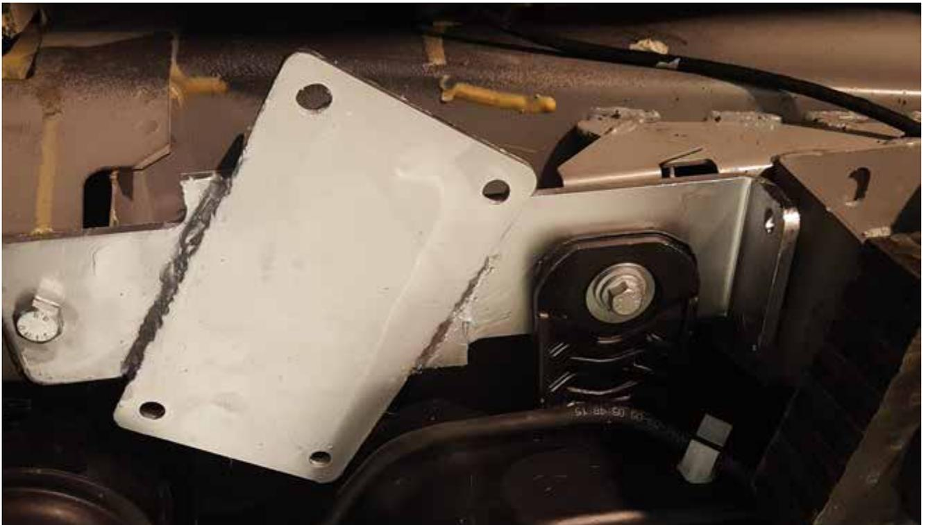
Fijar el adaptador con un tornillo M10 y fijar el soporte del depósito de AdBlue por encima del adaptador
