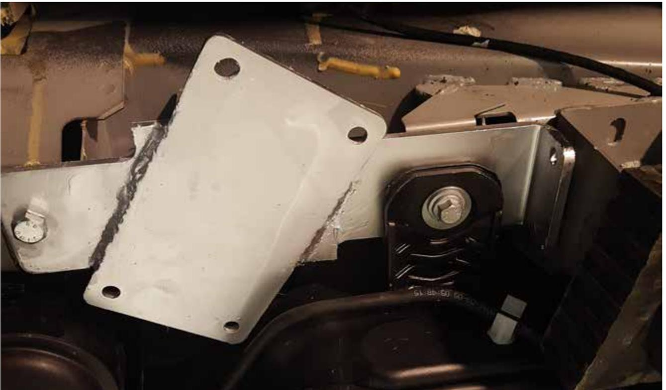
Befestigen Sie den Adapter mit einer M10 Schraube und befestigen Sie die Halterung des AdBlue-Tanks über dem Adapter
