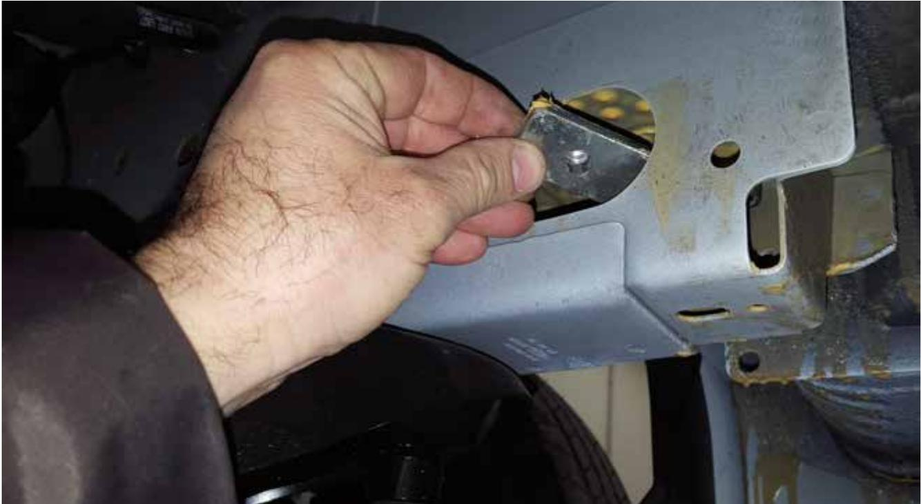
Introducir la placa de sellado a través del orificio del bastidor.
