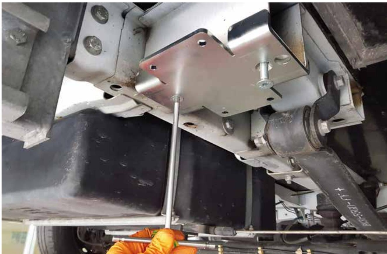
Posizionare l'adattatore nel punto illustrato (dietro l'asse posteriore), inserire le piastre di tenuta e fissare l'adattatore con i bulloni M10.
