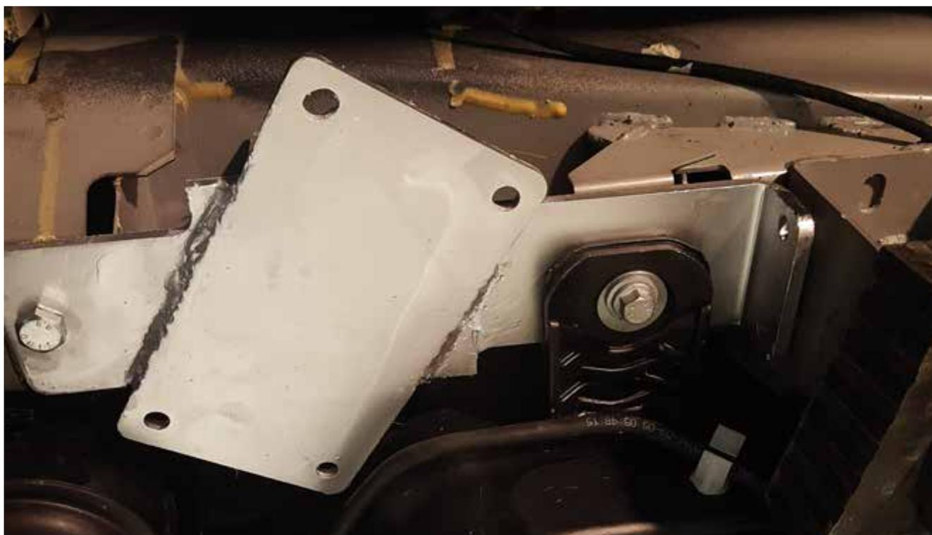
Fissare l'adattatore con un bullone M10 e fissare il supporto del serbatoio AdBlue sopra l'adattatore
