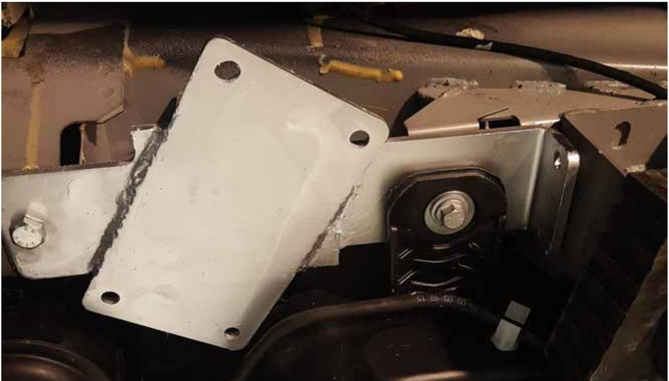
Fixez l'adaptateur avec un boulon M10 et fixez le support du réservoir Adblue au-dessus de l'adaptateur
