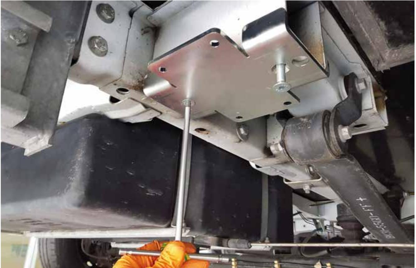
Coloque el adaptador en el punto ilustrado (detrás del eje trasero), inserte las placas de sellado y fije el adaptador con los tornillos M10.
