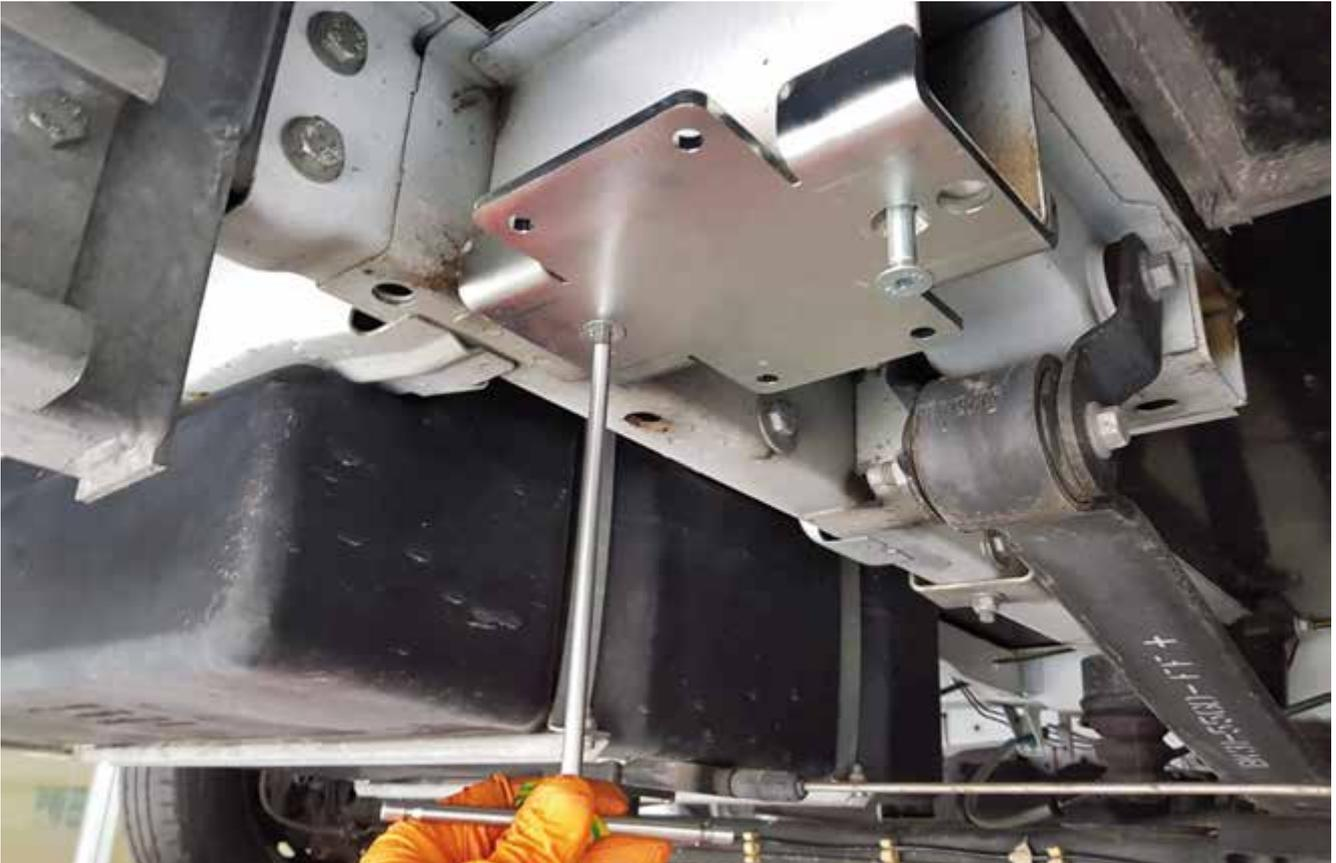
Placez l'adaptateur à l'endroit indiqué (derrière l'essieu arrière), insérez les plaques d'étanchéité et fixez l'adaptateur avec les boulons M10.
